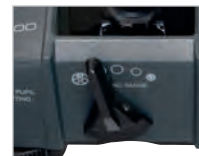
SynchronEinstellung von Parallaxe und Konvergenz.
