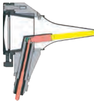
Direkte Beleuchtung mit Xenon Halogen- Technologie
