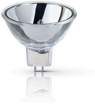
Philips Halogen-Reflektorlampen bieten die ideale Lösung für eine Vielzahl von medizinischen, wissenschaftlichen und Projektionsbeleuchtungssysteme. Die bewährte Zuverlässigkeit macht sie ideal für den nachträglichen Einbau. Dichroitische Reflektoren sorgen für Wärmeableitung in Richtung der Rückseite des optischen Systems, wodurch das beleuchtete Objekt geschont wird.
