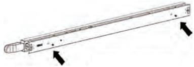
将盖板安装在壳体上，并使用紧固螺丝将盖板固定住
