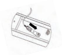
盖板上的地线插耳插入壳体内接地插片上
