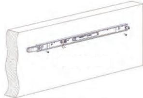
将盖板安装在壳体上，并使用紧固螺丝将盖板固定住
