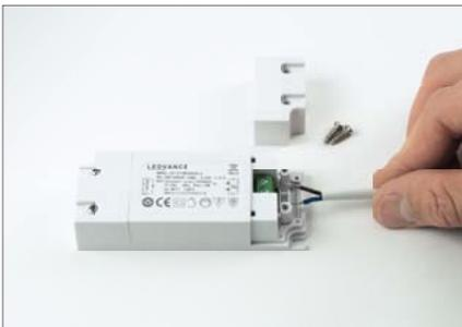
Schritt 1: Abdeckung und Anschlusskabel abschrauben
